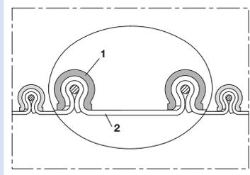
Tuyau Polyéthylène avec profilé de serrage (tuyau clippé)
