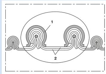
Tuyau à profilé de serrage (tuyau clippé), double couche, haute résistance chimique (jusqu'à +270°C)
