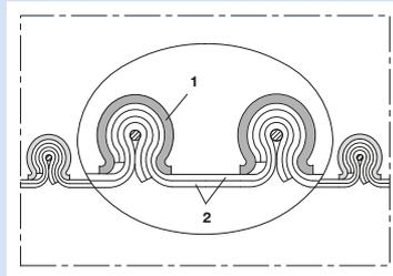
Tuyau à profilé de serrage (tuyau clippé) électro-conducteur, double couche, haute résistance chimique (jusqu'à +170°C)
