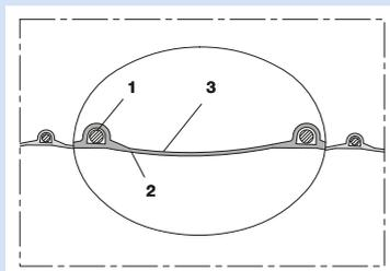
Tuyau Polyuréthane Antistatique, ultra léger, résistant à la migration des microbes dans la gaine, difficilement inflammable
