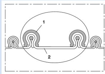
Tuyau PVC avec profilé de serrage (tuyau clippé), tenant jusque 120°C
