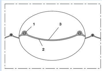
Tissu enduit Polyuréthane, (Jusqu'à 125°C)
