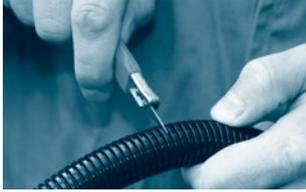
Étape 1: Séparer le tube et la crête d'ondulation (protection optimale du tube et du connecteur).
