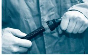
Étape 2: Insérer le tube dans le connecteur „fermé“ aussi loin que possible (pour assembler le connecteur).
