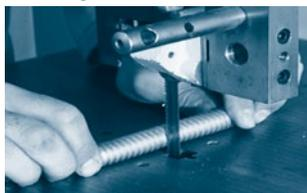
Sectionner avec une scie à ruban à une vitesse de coupe élevée.
