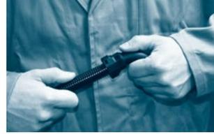
Étape 3: Tirer légèrement le tube ondulé à l'intérieur du connecteur (pour le verrouiller fermement).
