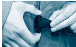
Étape 6: Poussez les „pattes“ d'arrêt (système d'assemblage NORDUC® prêt à être utilisé).
