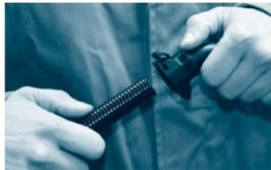
Étape 5: Tirer le tube ondulé du connecteur.
