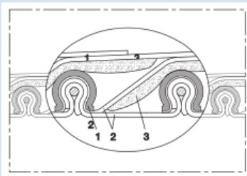
Tuyau haute température, tuyau à profilé de serrage (tuyau clippé), multi-couches, isolant, adapté pour une légère surpression (jusqu'à +700 °C)
