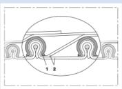
Tuyau haute température, tuyau à profilé de serrage (tuyau clippé), multi-couches, isolant, adapté pour une légère surpression (jusqu'à +550°C)
