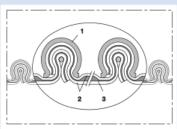
Tuyau haute température, tuyau à profilé de serrage (tuyau clippé), multi-couches, isolant, (jusqu'à +1100°C)
