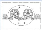
Hochtemperaturschlauch, Klemmprofilschlauch, mehrlagig, isolierend (bis 1.100°C)
