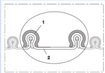
Tubo di serraggio elettricamente conduttivo, altamente resistente agli agenti chimici (fino a + 270 °C)
