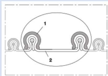
Tuyau à profilé de serrage (tuyau clippé) électro-conducteur, haute résistance chimique (jusqu'à +270°C)
