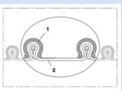
Tuyau à profilé de serrage (tuyau clippé) électro-conducteur, haute resistance chimique (jusqu'à +270°C)
