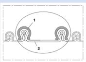
Elektrisch leitfähiger Klemmprofilschlauch, hoch chemikalienbeständig (bis +270°C)
