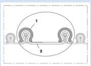
Tuyau à profilé de serrage (tuyau clippé), tuyau alimentaire et pharmaceutique, haute resistance chimique (jusqu'à +270°C)
