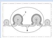
Tuyau à profilé de serrage (tuyau clippé), double couche, (jusqu'à +170°C)
