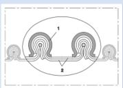
Tuyau à profilé de serrage (tuyau clippé) électro-conducteur, double couche, haute resistance chimique (jusqu'à +270°C)
