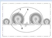
Tubo del gas di scarico, a prova di vibrazioni, profilo di protezione esterno
