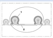
Tuyau Polyéthylène électro-conducteur avec profilé de serrage (tuyau clippé)
