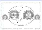
Tuyau d'évacuation de gaz d'échappement, résistant aux vibrations, avec un profil de protection externe
