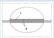
Tuyau/tube en Polyuréthane résistant à l'abrasion, paroi renforcée pour la pression
