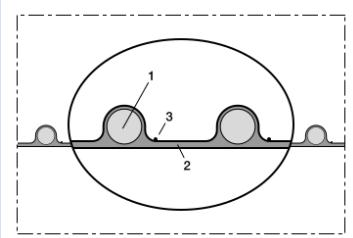
Tuyau Polyuréthane antistatique, léger, résistant à la migration de microbes dans la gaine, tresse de mise à la terre
