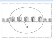
Tubo per aspirapolvere, antistatico  $<10^{11} \Omega$
