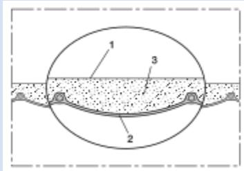
Tuyau de climatisation en aluminium/polyester, isolé, difficilement inflammable (M1)
