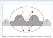
Tubo antistatico per alimenti e tubo farmaceutico, super pesante, filo di acciaio **INOX**
