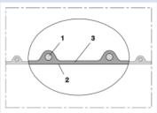
Tubo in poliuretano antistatico, peso medio, resistente ai microbi, ritardante di
