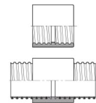
Connettore a vite per il collegamento, l'estensione e la riparazione di tubi a spirale, alimenti sicuri
