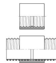
Connettore a vite per il collegamento, l'estensione e la riparazione di tubi a spirale, alimenti sicuri
