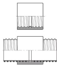
Connettore a vite per il collegamento, l'estensione e la riparazione di tubi a spirale, alimenti sicuri
