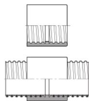
Raccord de tuyau spiralé pour le raccordement, l'allongement ou la réparation de tuyau spiralé, qualité alimentaire
