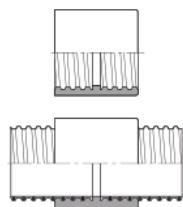
Raccord de tuyau spiralé pour le raccordement, l'allongement ou la réparation de tuyau spiralé, qualité alimentaire
