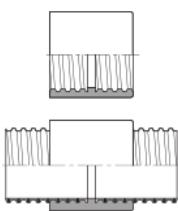
Raccord à visser pour le raccordement ou la réparation de tuyaux spiralés
