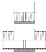
**Schraubverbinder zum Verbinden, Verlängern und Reparieren von Spiralschläuchen**
