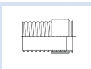
**TRI-Clamp Kupplung passend zu Stutzen nach DIN 32676**
