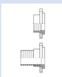
**Flangia libera per il montaggio delle flange di accoppiamento secondo DIN 2632/2633, schema di foratura DIN-EN 1092-1, grado alimentare**
