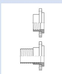
Raccord à visser avec bride libre selon DIN 2632/2633, modèle de trou DIN 2502
