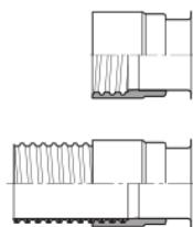
Tubo di erogazione mangimi compatibile con i più comuni sistemi di tubi nel settore della ventilazione, come Jacob standard, alimentare sicuro
