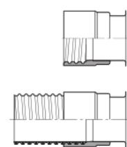
Raccord à visser avec bord tombé compatible avec les systèmes de raccordement Jacob, qualité alimentaire
