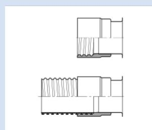
Bördelrohr kompatibel zu den gängigsten Rohrsystemen im Lüftungsbereich wie Jacob-Standard
