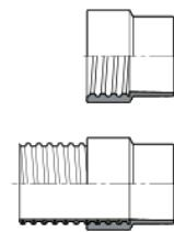
Weiche Muffe zum Aufschieben auf Stutzen oder Einschieben in Rohre, elektrisch leitfähig
