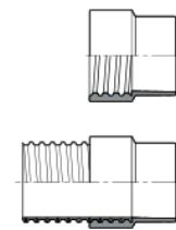
Weiche Muffe zum Aufschieben auf Stutzen oder Einschieben in Rohre, elektrisch leitfähig
