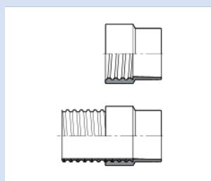
Weiche Muffe zum Aufschieben auf Stutzen oder Einschieben in Rohre, lebensmittelecht
