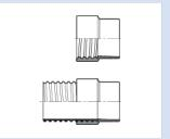
Weiche Muffe zum Aufschieben auf Stutzen oder Einschieben in Rohre
