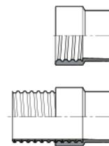
Weiche Muffe zum Aufschieben auf Stutzen oder Einschieben in Rohre
