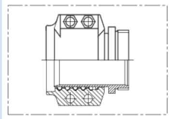
Système de raccordement spécial de sécurité pour silos et camions-silos avec accouplements/raccords: Storz, raccord fileté, etc.
