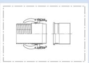
Anschlussteile zum Verbinden und Befestigen von Metallschläuchen
