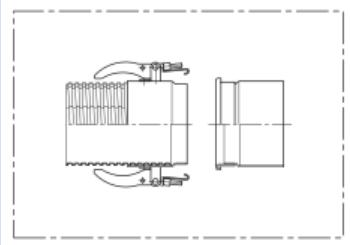
Anschlusssteile zum Verbinden und Befestigen von Metallschläuchen
