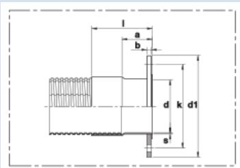
Anschlusssteile zum Verbinden und Befestigen von Metallschlüchen
