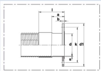
Anschlusssteile zum Verbinden und Befestigen von Metallschlüchen
