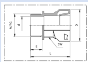
Raccord plastique; fil de liaison rigide
