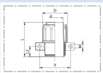
Raccord plastique avec douille intérieure intégrée; bride de montage rotatif
