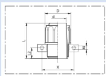
Kunststoff-Schlauchverschraubung mit integrierter Innentülle; drehbarer Befestigungsflansch
