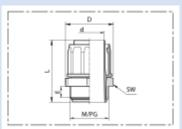
Kunststoff-Schlauchverschraubung mit integrierter Innentülle; drehbares Anschlussgewinde
