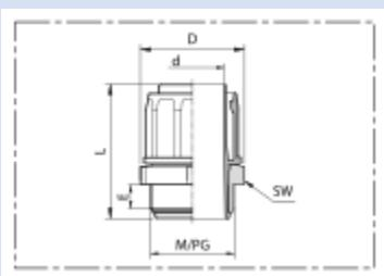
**Kunststoff-Schlauchverschraubung mit integrierter Innentülle; drehbares Anschlussgewinde**
