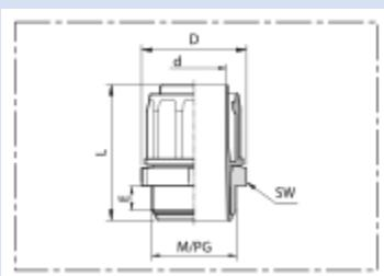
Kunststoff-Schlauchverschraubung mit integrierter Innenfülle; drehbares Anschlussgewinde
