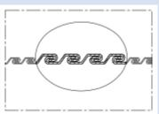
Tubo di protezione in acciaio inossidabile inossidabile e altamente flessibile; estremamente robusto; profilo metallico doppio piegato
