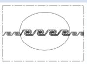
Rostfreier und hochflexibler Edelstahl-Schutzschlauch; extrem robust; doppelt gefalztes Metallprofil
