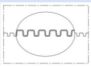
Tubo di protezione in plastica corrugato parallelo in PA6; altamente flessibile e a tenuta stagna
