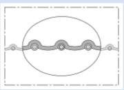
Tubo protettivo in poliuretano resistente all'abrasione, resistente all'olio e robusto; a tenuta stagna; Spirale: filo di acciaio per molle rivestito in plastica
