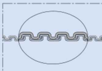
Abriebfester, ölbeständiger und mit Polyurethan ummantelter Metall-Schutzschlauch; sehr robust und flüssigkeitsdicht; eingehaktes Metallprofil
