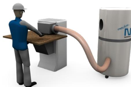
Aspirazione della polvere di legno: macchina CNC, centro di lavoro CNC (specialmente per sistemi a movimento rapido)
